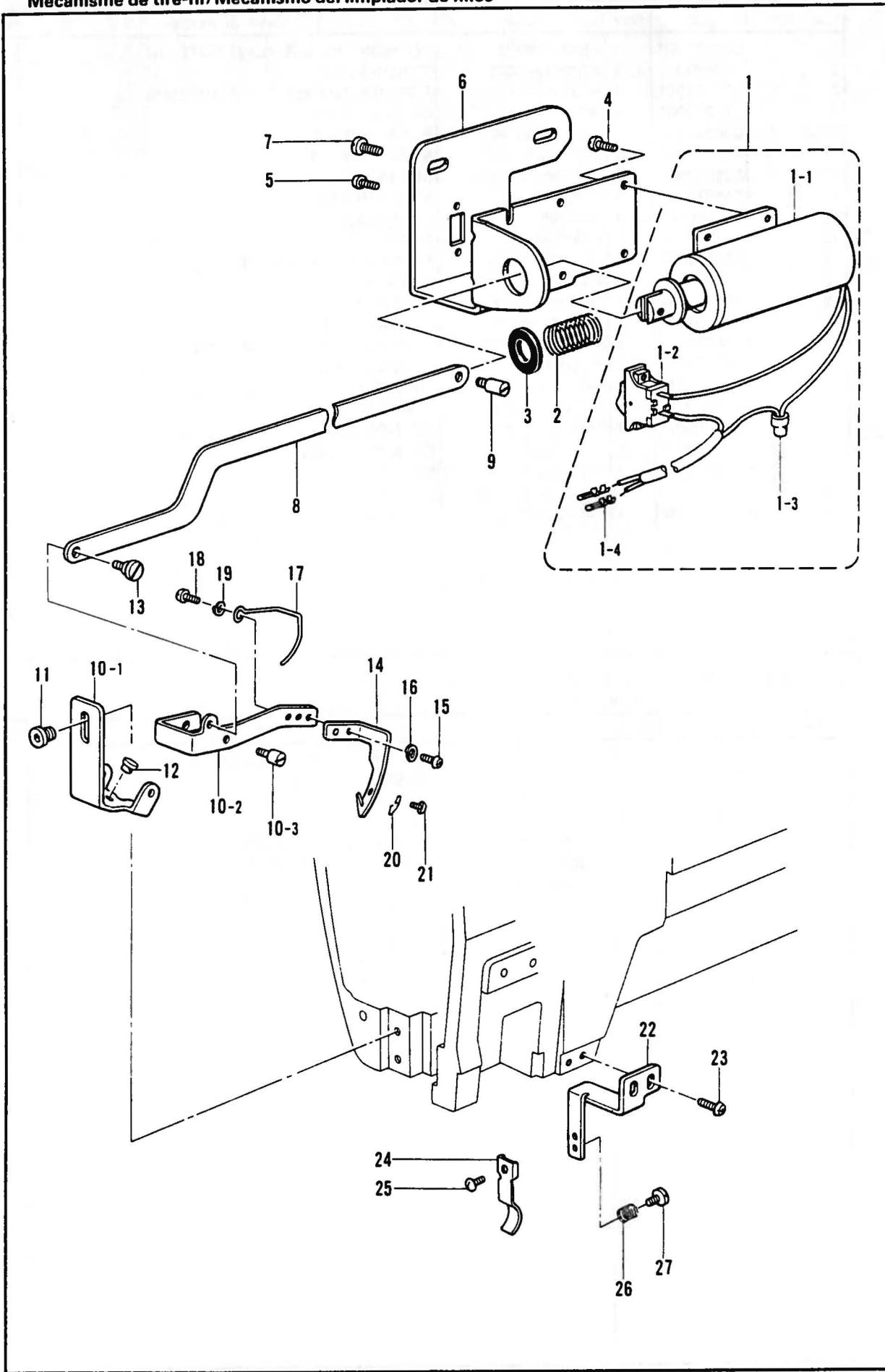
P. 糸払い関係/Thread wiper mechanism/Fadenwischvorrichtung/
