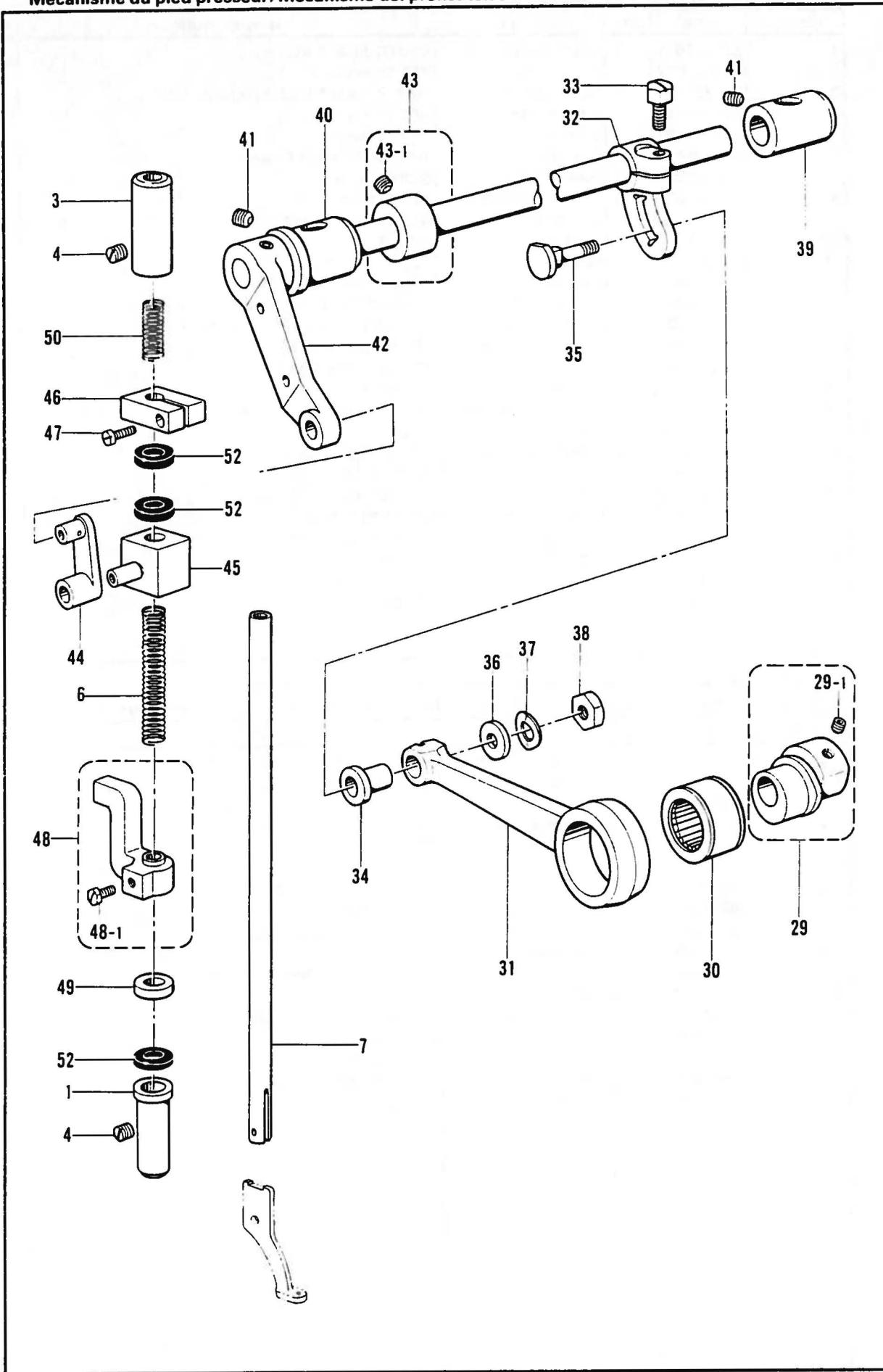
D. 押工関係/Presser foot mechanism/Stoffdrückerfuß/
