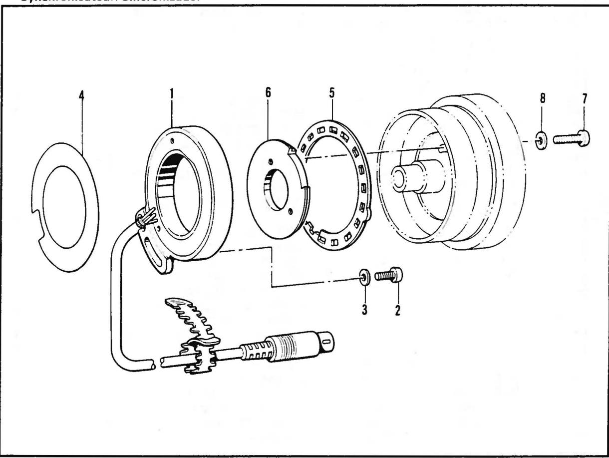
M. 糸ユルメ関係 / Tension release mechanism / Spannungsverminderungsvorrichtung /
